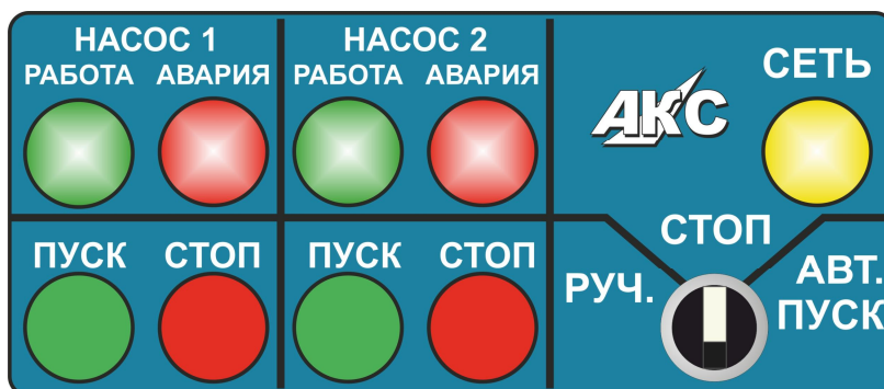
Вид органов управления на передней панели шкафа.
